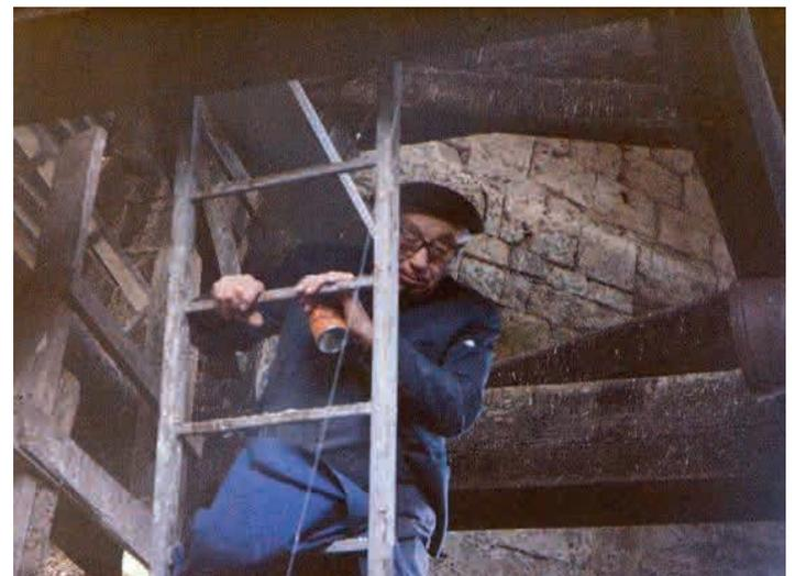
L'horloger va lubrifier la commande du marteau de la cloche. - Photo D.Cour.
